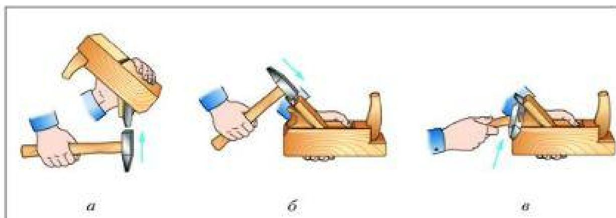
Рис. 10. Установка ножа в рубанок с деревянной колодкой: а – настройка выступа лезвия над подошвой; б – закрепление ножа с помощью клина; в – устранение перекоса ножа
