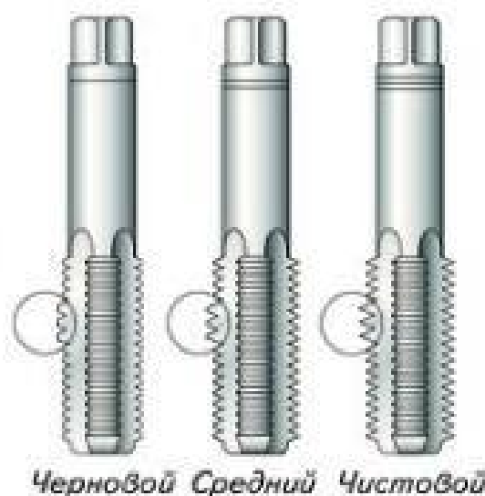
Рис. 63. Метчики: а – основные элементы; б – комплект для нарезания метрической резьбы
