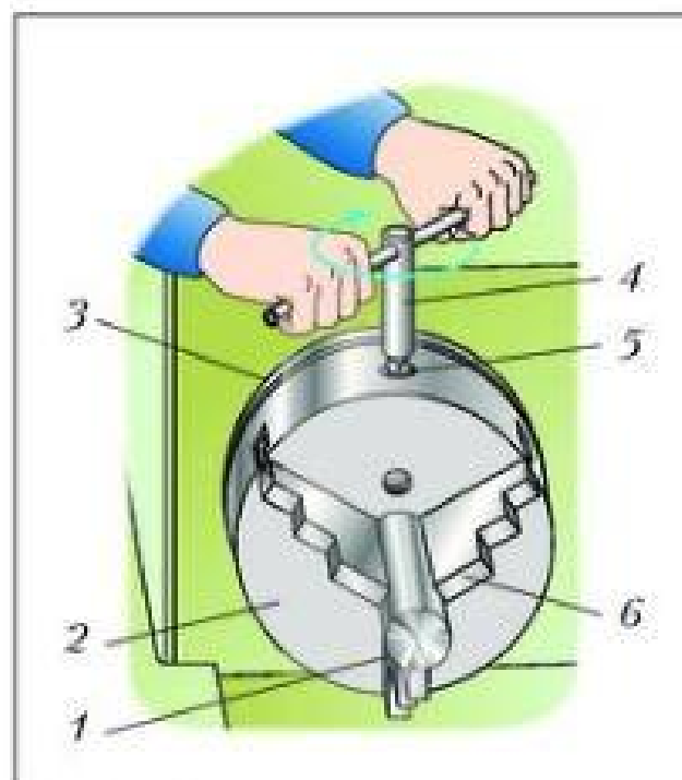
Рис. 50. Установка заготовок в трёхкулачковый патрон: 1 – заготовка; 2 – корпус патрона; 3 – планшайба; 4 – ключ; 5 – отверстие под ключ; 6 – кулачки
